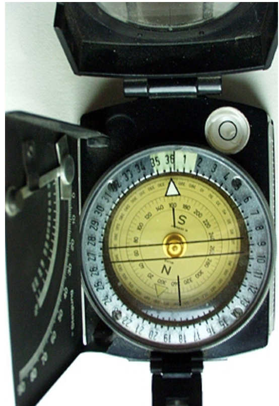
Bussola di precisione (ago in bagno d'olio) Inclinometro, ghiera graduata girevole e bolla (per uso topografico)
