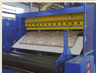
Fase produttiva pannelli Geoprotex ® -Bioedil Tipo A
